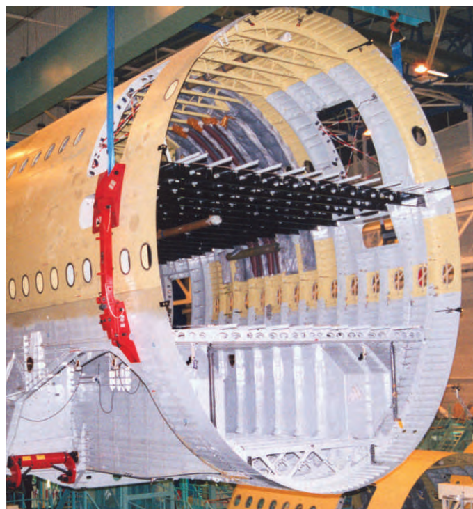
Rys. 4. Kadłub samolotu wykonany z kompozytów
